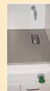
Краны и гибкие подводки для подачи газа, воды, вакуума, сжатого воздуха с дистанционным управлением с передней панели шкафа
